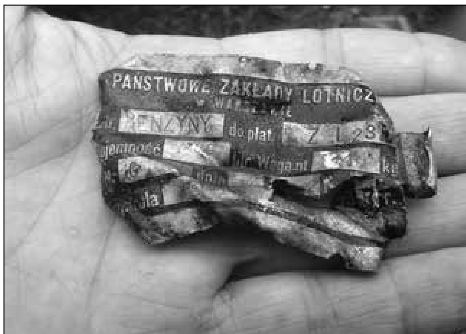
Tabliczka znamionowa tylnego skrzydłowego zbiornika paliwa; widoczny typ samolotu - PZL.23B, rok produkcji 1937, pojemność zbiornika 49 l, nr seryjny zbiornika 1613 P (prawy), waga netto 11 kg
