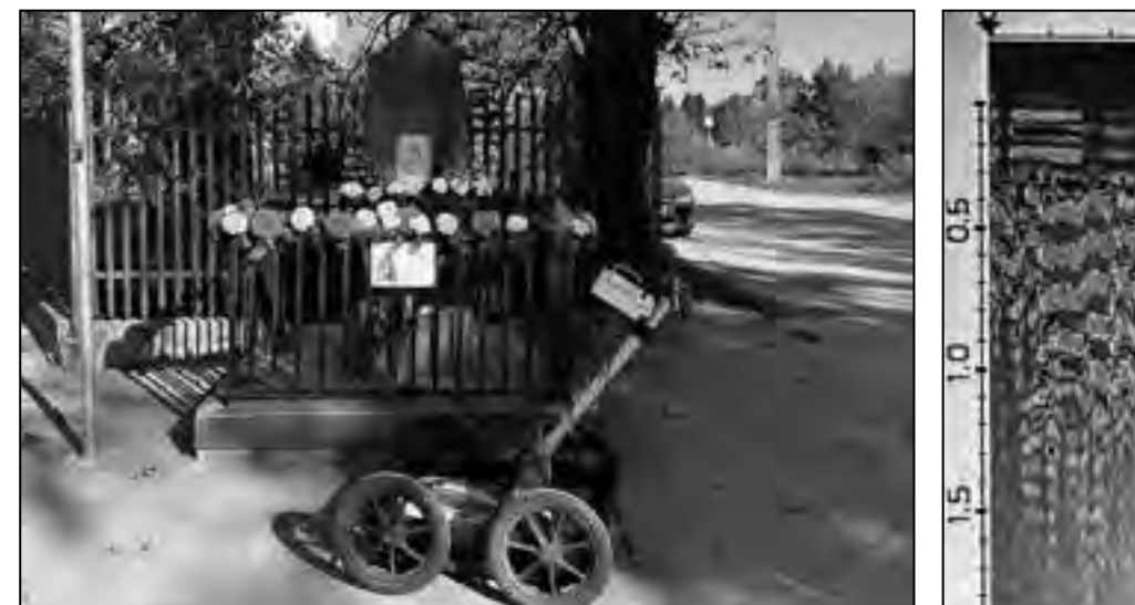
Grób powstańców przy skrzyżowaniu ul. Kościelnej, Kraszewskiej i Radzywińskiej; obok echogram z pomiaru wykonanego w miejscu, gdzie stoi georadar, z widocznym na głębokości ok. 1,2 m śladem pochówku
